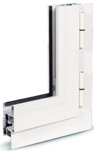
Serramenti costruiti con profilati estrusi in lega di alluminio 6060 (EN 573-3), con stato di fornitura T5 (EN 515) e tolleranze su dimensioni e spessori secondo UNI EN 12020.2 e/o UNI EN 755-9.
