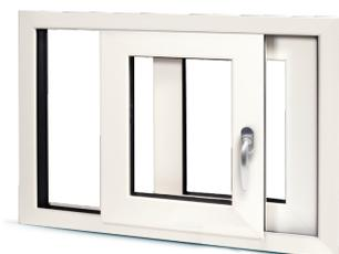
Serramenti di tipo scorrevole in linea, costruiti con profilati estrusi in lega di alluminio 6060 (EN 573-3), con stato di fornitura T5 (EN 515) e tolleranze su dimensioni e spessori secondo UNI EN 12020.2 e/o UNI EN 755-9.
