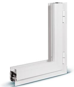
Serramenti costruiti con profilati estrusi in lega di alluminio 6060 (EN 573-3), con stato di fornitura T5 (EN 515) e tolleranze su dimensioni e spessori secondo UNI EN 12020.2 e/o UNI EN 755-9.
