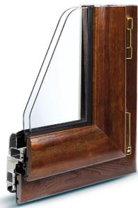
Fornitura e messa in opera di Serramenti misti in alluminio-legno, con struttura portante costruita con estrusi in alluminio, lega EN AW 6060, secondo le norme UNI 900611 con stato di fornitura T5 e tolleranze dimensionali e spessori secondo le norme EN 1202012, nella parte esterna, e con masselli in legno scorniciati nella parte interna.
